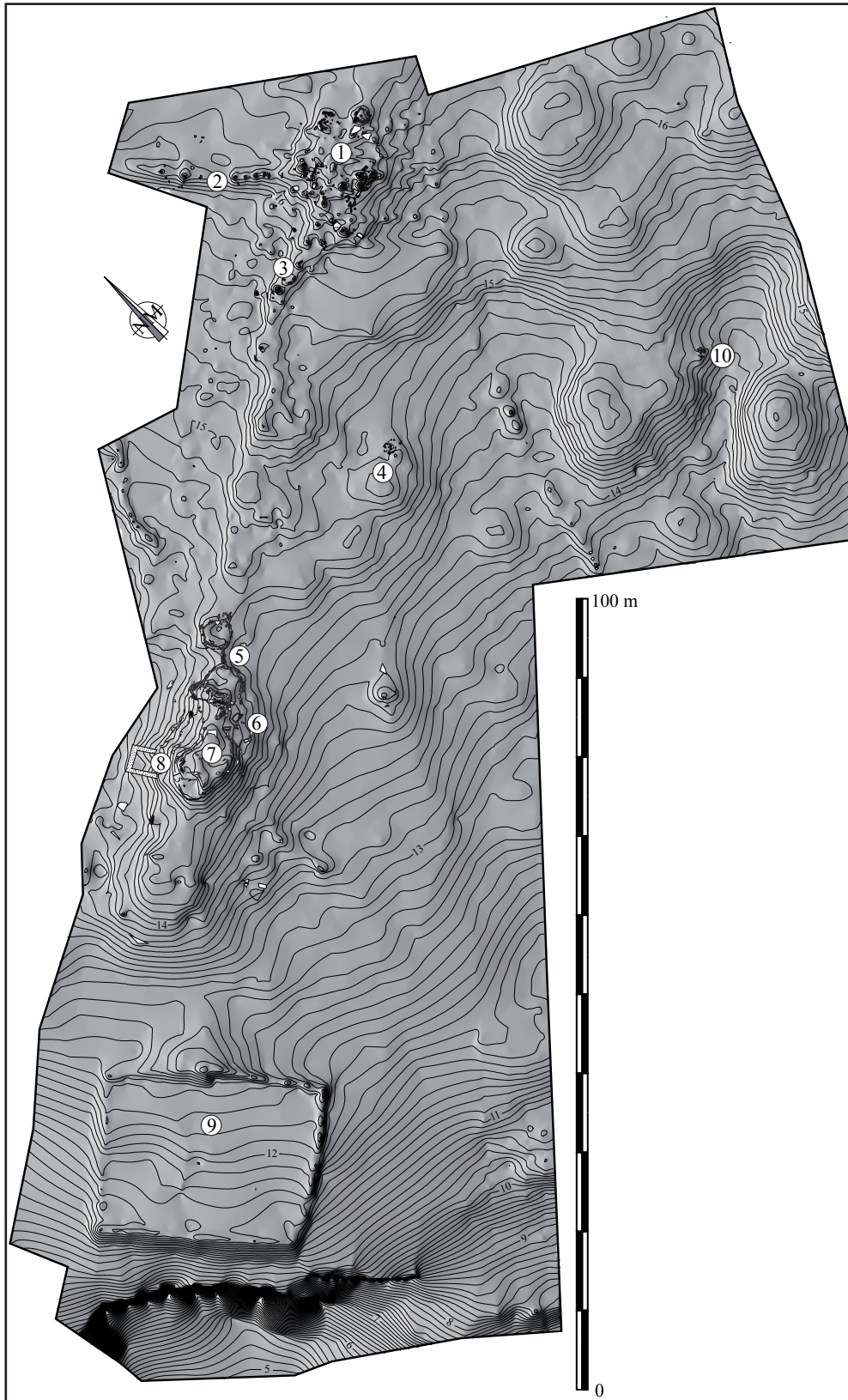
Fig. 1 : Modèle Numérique de Terrain de la nécropole mégalithique de Zoulierou (Ile Molène, Finistère, Bretagne, France). Equidistance des isolignes : 0,10 cm. Relevé GPS et traitement des données : S. Pacaud (Géolittomer, Nantes) - Relevés manuels : Y. Sparfel, Y. Pailler, A. Leroy, Y. Guéguen, E. Ihuel, J. Josselin, V. Leroux, A. Lourdeau, J. Meslin, R. Le Floc'h, 2001-2002.
